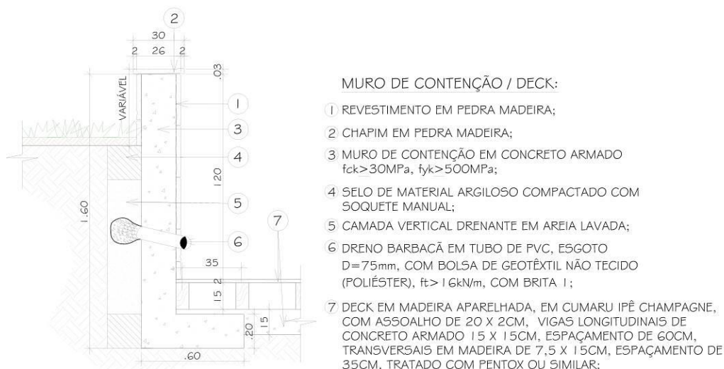
Figura 02 - Detalhe construtivo DC04 - Muro de contenção / Deck. Fonte: Projeto Executivo de Urbanização – Prancha THEO2315-URBEXE-06.
