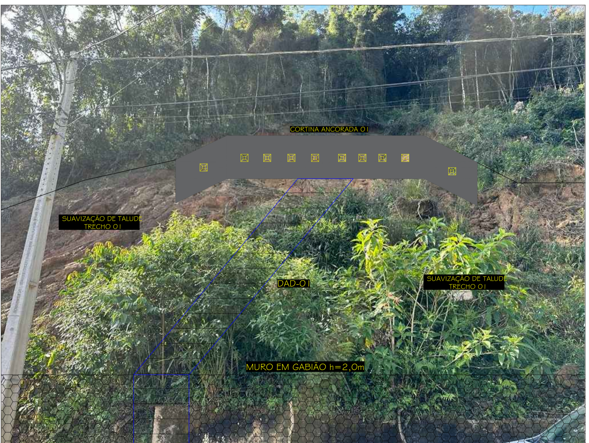
4 TALUDE COM INTERVENÇÕES PROPOSTAS SEM ESCALA
